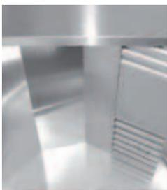
Costruzione monoblocco in acciaio inox 18/10 AISI 304 con finitura Scotch-Brite®, la superficie aspirante posta frontalmente ed il deflettore posteriore consentono un'agevole captazione di fumi e vapore e la rende adatta ad essere installata sopra a forni.
